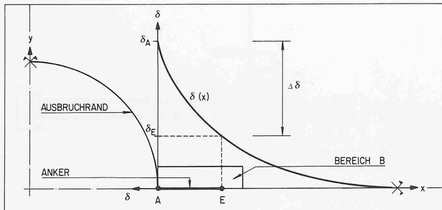
(A, E). Beim *Freispielanker* (Sprezhül- senanker), bei dem das Gestänge nur in den Punkten A und E durch Ankerplatte bzw. Sprezhülse mit dem Fels verbunden ist, lässt sich die Spannkraft in der Ankerstange über die Dehnung und den Elastizitätsmodul der Ankerstange einfach ableiten. Diese Spannkraft wird beim Sprezhül- senanker über die Ankerplatte in den Fels eingeleitet und erzeugt einen Ausbauwiderstand.
