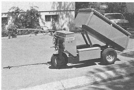
Bild 3a. Elektrohewagen. Kippermodell
