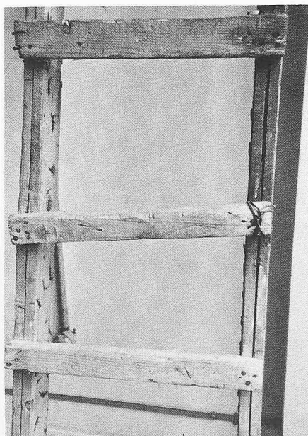
Bild 29. Aus Bauholzabfällen gefertigte Leiter in einem holzarmen Entwicklungsland. Im schlüsselfertigen Projekt war keine Leiter vorgesehen
