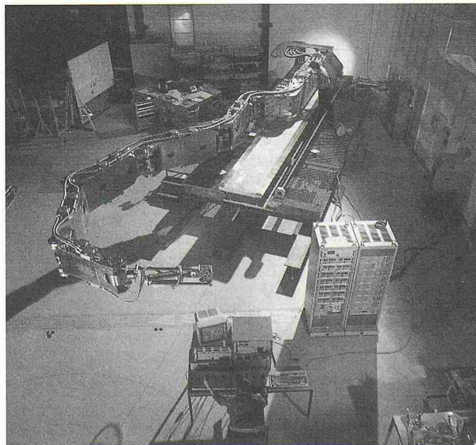
Für den Einsatz bei Wartungsarbeiten im Tokamak-Testreaktor in Princeton, USA, wurde dieser 9 Meter lange rechnergesteuerte Manipulatorarm entwickelt (Bild: KfK)
