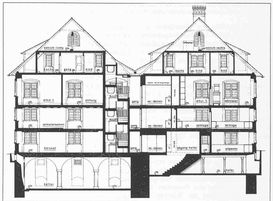
Schnitt durch das Hauptgebäude
