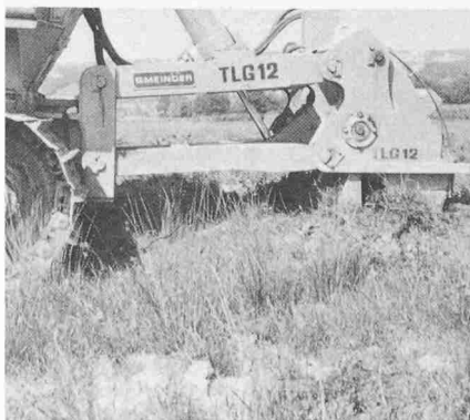
Bild 3. Lockerungsaggregat des Tieflockerers, mit dem die Versuche durchgeführt werden
