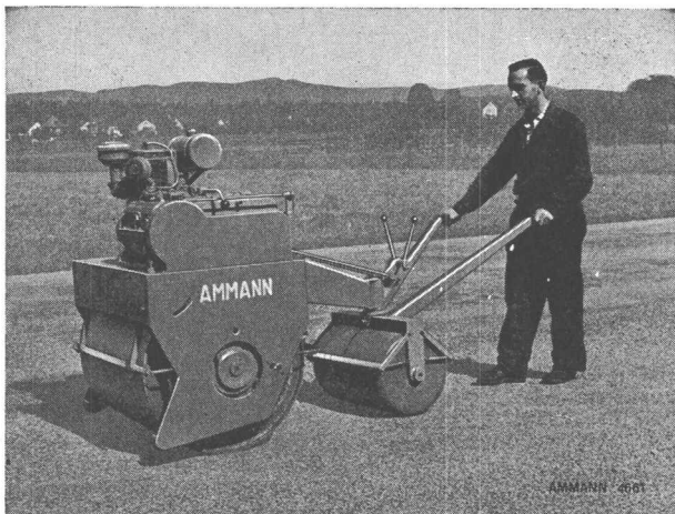
Selbstfahrende Vibrowalze Type LM, mit Lenkwalze
