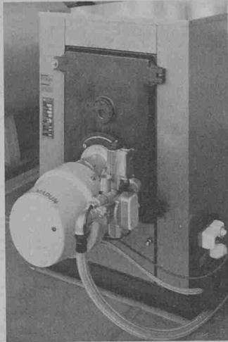
durch sichere Magnetventile abgesperrt.
