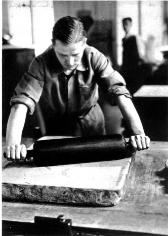
Der Stein wird eingefärbt um Probeabzüge herzustellen
