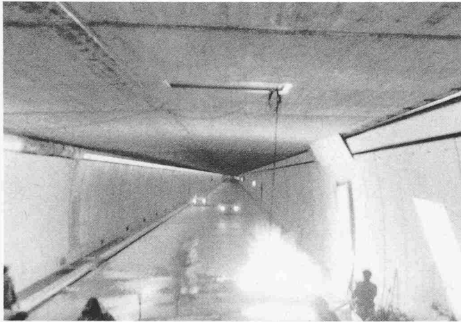
Bild 3. Seelisberg-Autobahntunnel, Brandversuche: Situation im Tunnel, 3 Sekunden nach Entzündung von 18 Litern Benzin
