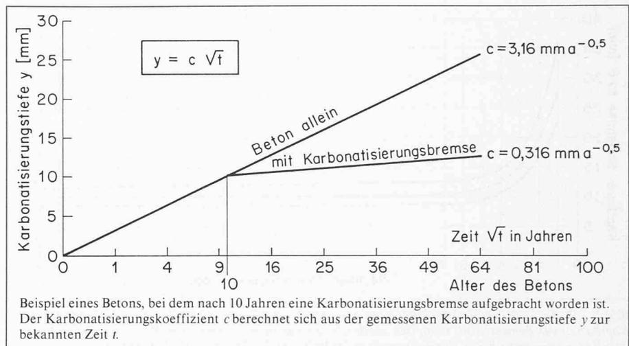
Bild 5. Geschwindigkeitsverlauf der Karbonatisierung (nach H. Weber[1])
