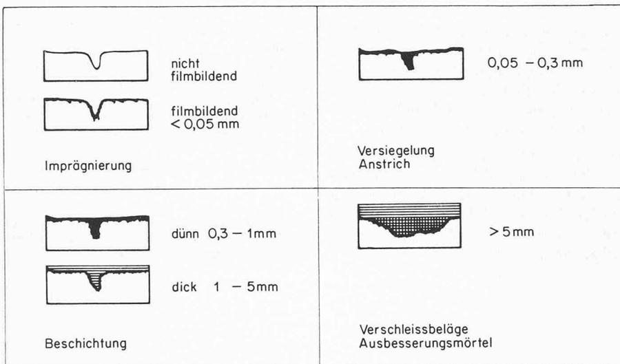
Bild 4. Schichtdicken verschiedener Oberflächenbehandlungen (nach F. Baré[1])
