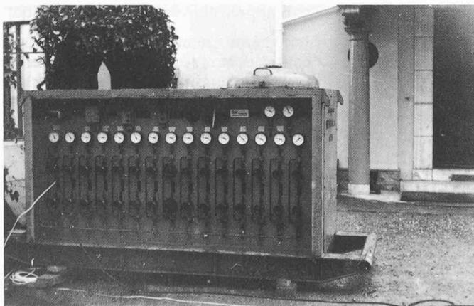
Fig. 9. Système de mesure des soulèvements de l'immeuble
