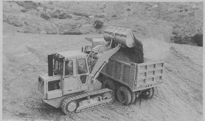
Der neue Caterpillar-Kettenlader 943. 11,2 t Einsatzgewicht, 60 kW (80 PS) Motorleistung, Kübelinhalt 1150 l.
