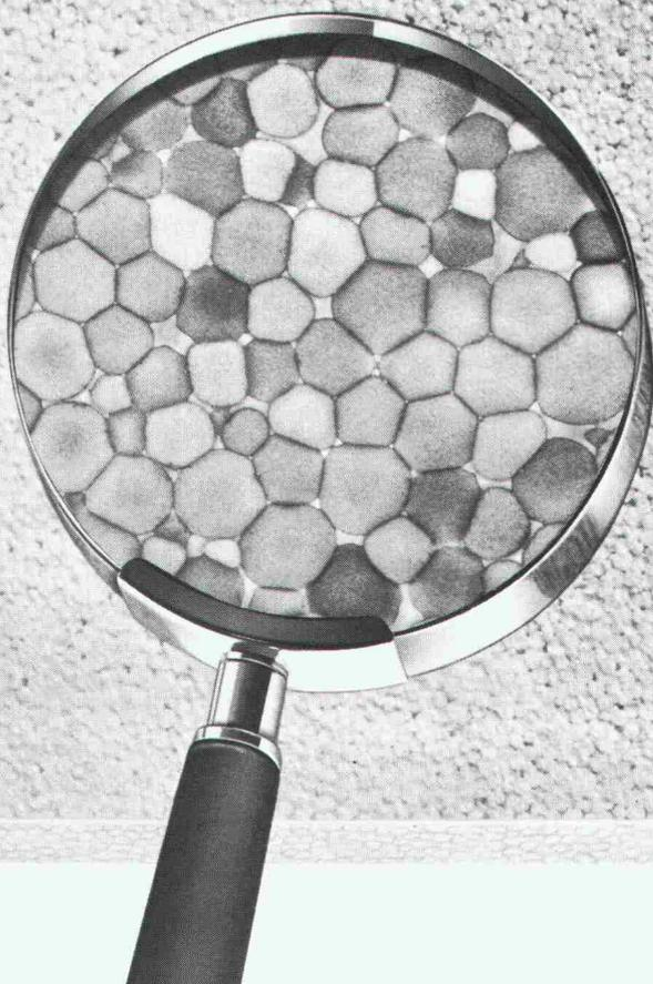
**1 m<sup>3</sup> Polystyrol-Hartschaum besteht aus rund 3-6 Milliarden mikroskopisch kleinen luftgefüllten Zellen. Darauf beruhen die hervorragende Wärmedämmfähigkeit und die hohe Druckfestigkeit von Polystyrol-Hartschaum. Das leichte Eigengewicht und die vielen anderen vorzüglichen Eigenschaften machen Polystyrol-Hartschaum zum idealen Isoliermaterial.**
