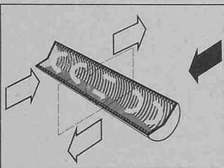
Kapillarstrukturiertes, patentiertes Wärmerohr im ständigen Kreislauf von Verdampfung und Kondensation
