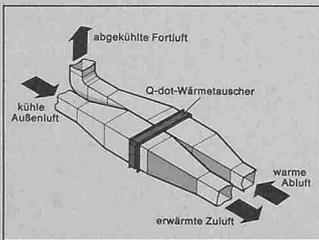
Mit dem Q-dot-Wärmetauscher lassen sich bis zu 80% Temperaturwärme zurückerlangen
