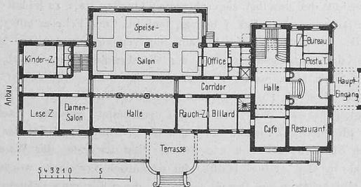
Grundriss vom Erdgeschoss. — Masstab 1 : 800.
