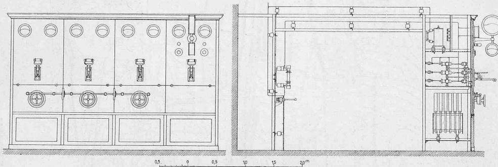
Abb. 9. Die Apparatenanlage. Ansicht und Querschnitt. — Masstab 1:60.
