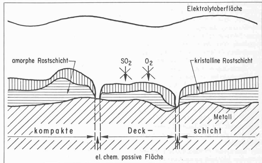
Bild 12. Schematische Darstellung der Rostschicht eines schlecht bewitterten wetterfesten Stahles
