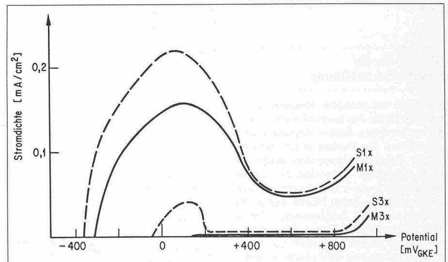
Bild 10. Anodische Stromdichte-Potentialkurven nach 20 Min. Immersion in 0,1 M Na<sub>2</sub>SO<sub>4</sub>-Lösung, Potentialvorschub: 15 mV/Min.
