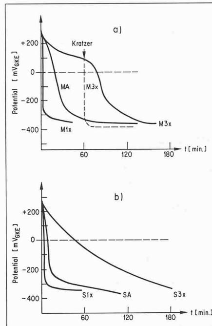
Bild 9. Potentialabfall nach dem Eintauchen der Proben in 0,1 M Na<sub>2</sub>SO<sub>4</sub>-Lösung
