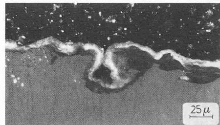
Bild 7. Querschliff durch die Rostschicht, Bewitterung 3×
