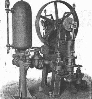
**Kolbenpumpen** für jede Druckhöhe, als Fabrikpumpen und zur Wasserversorgung von Villen, Hotels und ganzer Ortschaften. **Hochdruck- und Presspumpen** für Drücke bis 200 und mehr Atmosphären, eventuell in Verbindung mit Accumulatoren. **Zentrifugalpumpen**, hauptsächlich für Bauzwecke, **Hochdruck-Turbinenpumpen** für Riemenantrieb oder direkten Antrieb durch Elektromotoren. **Rotationspumpen, Schraubepumpen** für Handbetrieb.
