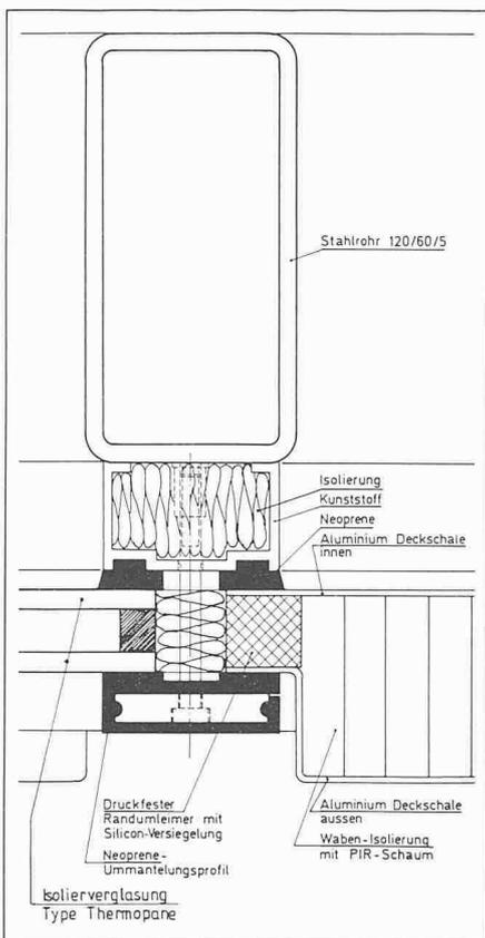
Bild 1. Ein komplexes Heizelement der integrierten Stahlfassade
