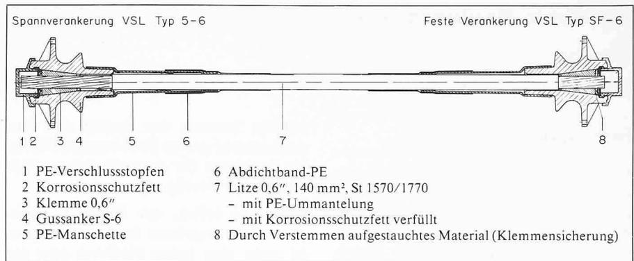
Bild 3. Einzelspannglied ohne Verbund des Spannverfahrens VSL
