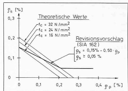
Bild 2. Bewehrungsgehalte, um eine Risseverteilung zu gewährleisten
