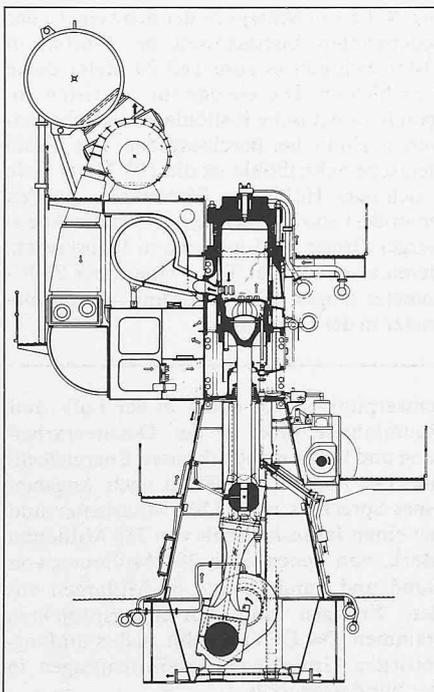
Längsschnitt durch das Kraftwerk mit dem 10RNF90M-Dieselmotor zur kombinierten Erzeugung von Wärme und Kraft mit 87,2 Prozent Gesamtwirkungsgrad. Beachtlich ist die Grösse des Abgaskessels mit Zusatzbrenner
