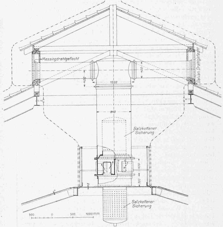
Abb. 7. Ventilationsaufsatz mit den Blitzsicherungen. — 1 : 50.
