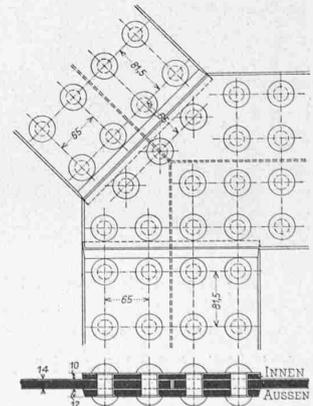
Abb. 4. Nietenanordnung in einem Eckstoss des Bodens. — 1 : 10.
