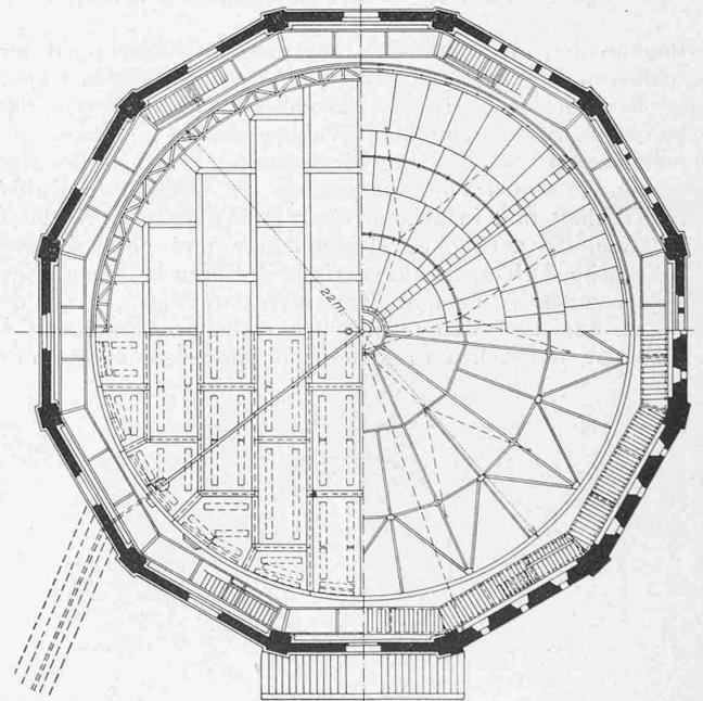
Abb. 3. Horizontal- und Vertikalschnitte des Behälters. — 1 : 300.
