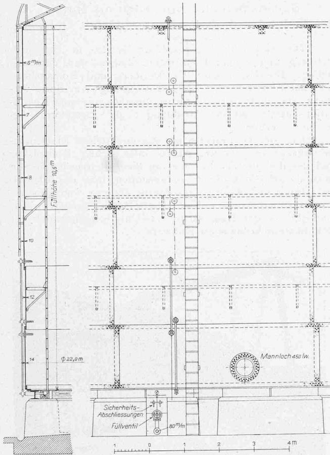
Abb. 5. Schnitt und Ansicht des Behälters. — Masstab 1 : 100.
