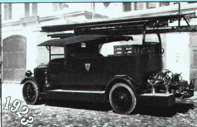
1923 Feuerlösch-Automobil der Stadt Winterthur mit dreistufiger Sulzer-Feuerlösch-Zentrifugalpumpe, Typ FCP.
