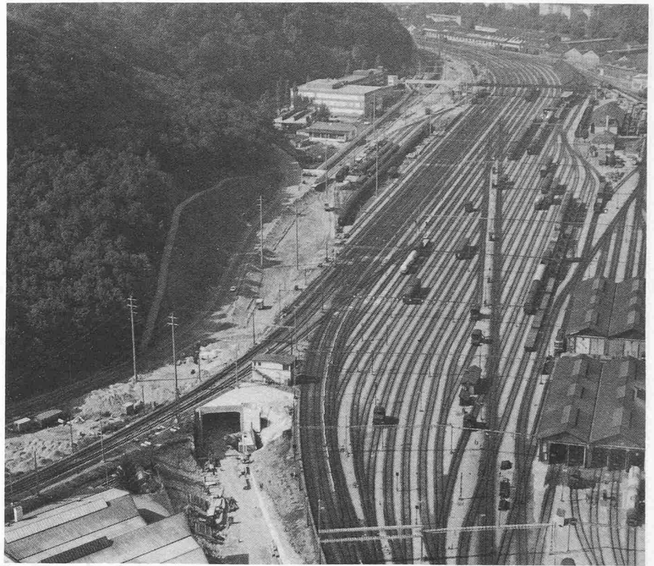
Bild 4. Luftaufnahme der Gleisanlagen nördlich des Personenbahnhofes Olten. Links neugestalteter Hangfuss des Hardchopfes, davor Nordportal Überwerfungsbauwerk/Tannwaldtunnel
