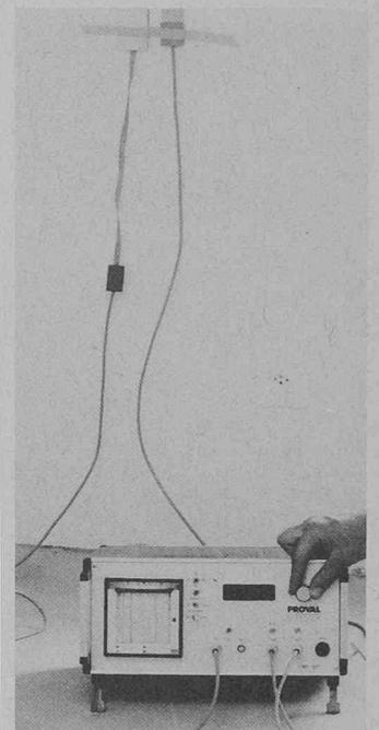
und Wärmebrücken lassen sich lokalisieren. Der Proval-k-Tester ist ein handliches Hilfsmittel für energiebewusstes Bauen.
