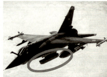
Capteur ELINT ASTAC emporté en station centrale sous un mirage F1CR de l'Armée de l'Air.
