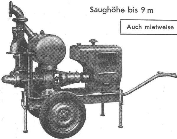
Leistungen 1—5000 l/sek. Kein Bodenventil. Keine Klappe im Saugstutzen. Keine Hilfs-Vakuum-Pumpe. Jederzeitiges automatisches Ansaugen auch nach Luffeintritt im Saugrohr. Keine reibenden, sich abnützenden Dichtungsflächen, daher störungsfrei auch bei Schlamm-, Sand- und Kiesförderung.
