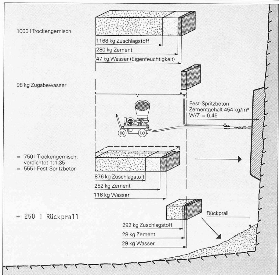
Bild 2. Materialbilanz eines Spritzbetons aus der Standardmischung
