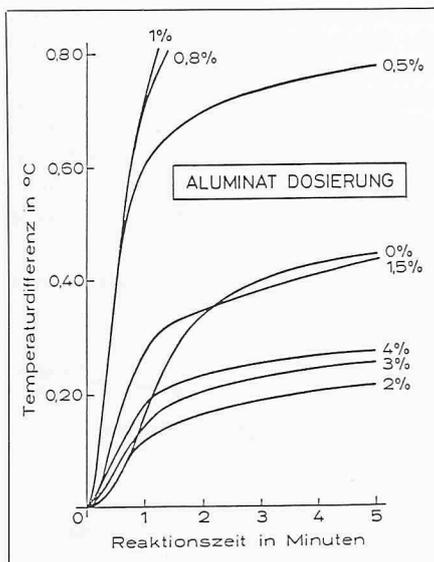
kinetische Versuche zeigten, dass die Wirkung der Aluminate zementabhängig und nur in einem relativ engen Dosierbereich optimal ist. Tiefere oder höhere Dosierungen verlängerten die Abbindezeiten wieder (Bild 5). Vorversuche erscheinen deshalb empfehlenswert, denn maximale Beschleunigungen wurden bereits mit Zugaben von 0,5 bis 1% erreicht.
