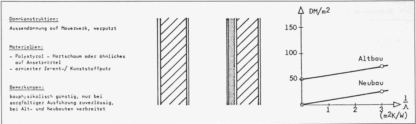
Bild 7. Beispiel einer Wärmeschutzkonstruktion mit zugehöriger Kostenkurve
