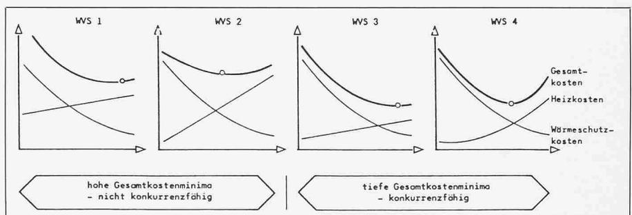
Bild 2. Evaluation von Wärmeversorgungssystemen (WVS) durch Vergleich der Gesamtkostenminima bezüglich einer baulichen Situation
