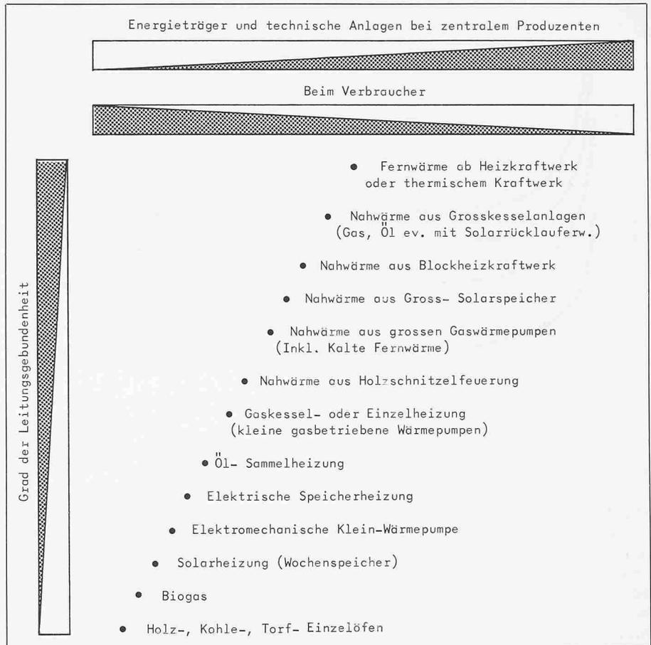
Bild 11. Untersuchte Wärmeversorgungssysteme
