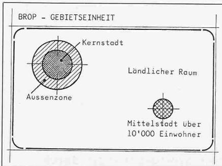
Bild 5. Raumstrukturmodell, schematische Gliederung der Raumtypen (RT)
