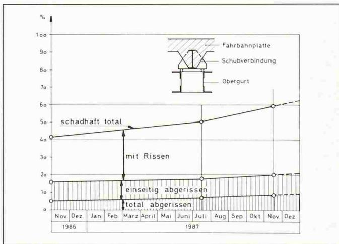
Bild 9. Entwicklung der Schweissnaht-Risse an den Schubverbindungen
