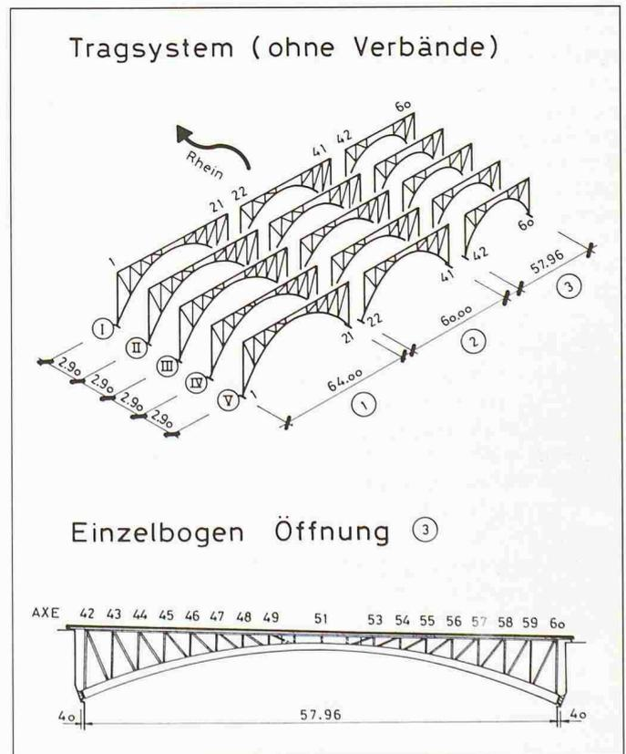
Bild 4. Schema des Bogentragwerks
