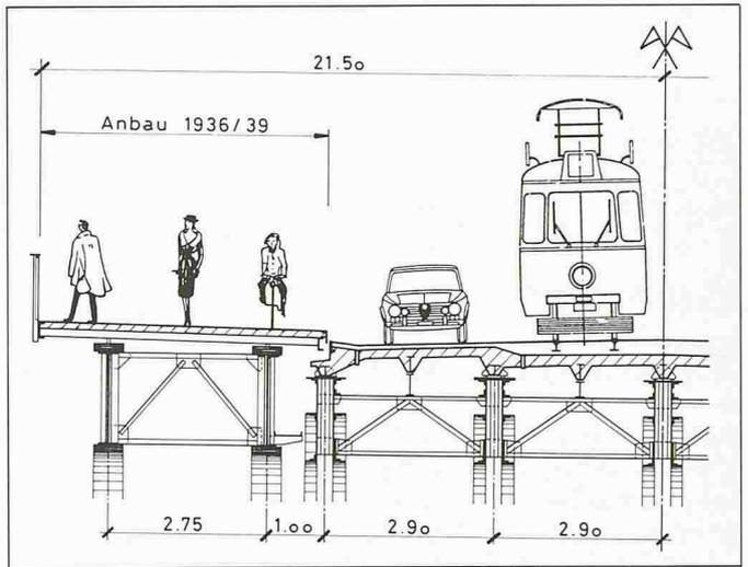
Bild 2. Brückenquerschnitt
