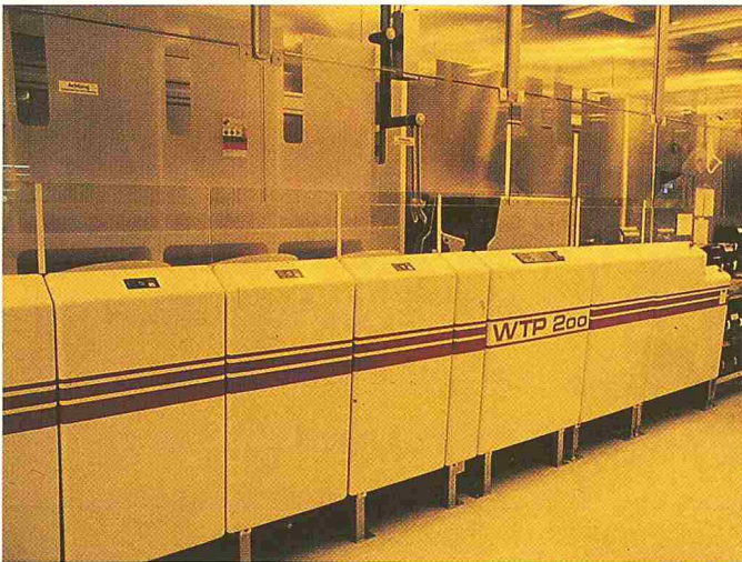
Bild 6. Die Reinigungsstation WTP (Wet Tank Processor) dient dem nasschemischen Prozessieren von Siliziumscheiben. Ein Roboter transportiert die Fertigungslose durch eine Reihe von Prozessstanks mit ätzenden oder Lack entwickelnden Chemikalien. Danach werden die Wafer mit Wasser gespült und in Schleudertrommeln getrocknet
