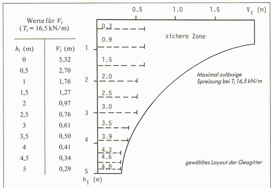
Bild 18. Tiefen  $T_i$  und entspr. Abstände  $V_i$
