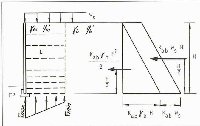
Bild 12. Beispiel Stützmauer
