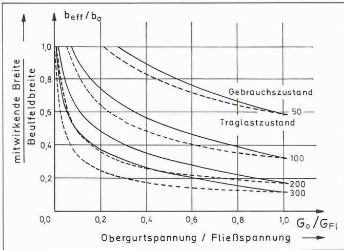
Bild 4. Einfluss der Obergurtspannung auf die mitwirkende Breite für verschiedene Beulfeldbreiten (Blechdicke  $t_N = 0,75$  mm,  $\sigma_{Fl} = 320$  N/mm<sup>2</sup>)
