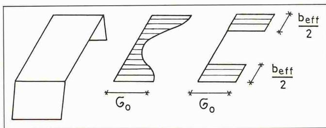
Bild 2. Spannungsverteilung einer gedrückten, seitlich eingespannten Platte und Aufteilung in mitwirkende Breiten
