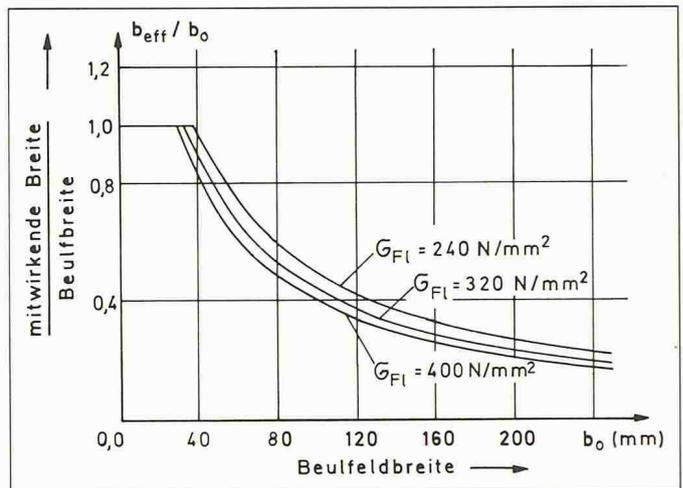
Bild 3. Verhältnis der mitwirkenden Breite ( $b_{eff}$ ) zur Beulfbreite ( $b_{beul}$ ) für verschiedene Fließspannungen
