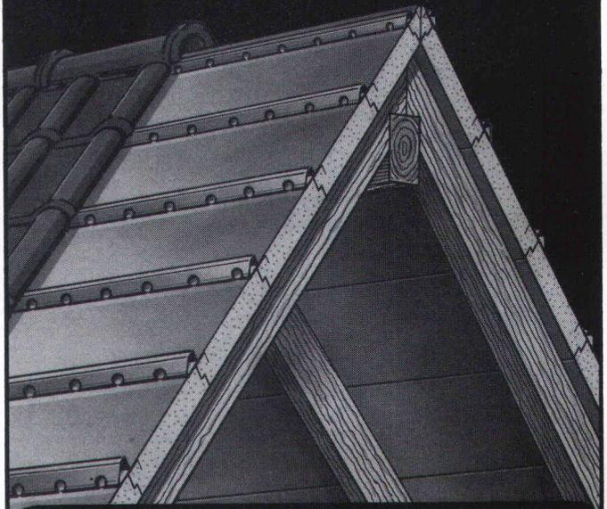
Nirgendwo im Haus geht normalerweise so viel Wärme und Geld verloren wie durchs Dach. Doch mit Polytec ist das Isolationsproblem schnell und einfach unter Dach und Fach. Denn Polytec hat einen einzigartigen Elementaufbau: hochdämmender PUR-Schaum, Aluminium-Ummantelung und integrierte Metallprofilatte mit Wasserführung und Hinterlüftung.
