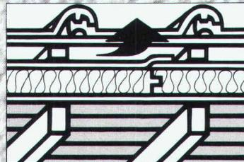
**4.** Das ideale Format  $213 \times 47 \text{ cm} = 1\text{m}^2$  bringt den Vorteil, dass die Isolationsplatte statisch richtig auf mindestens 3 Sparren aufliegt.
