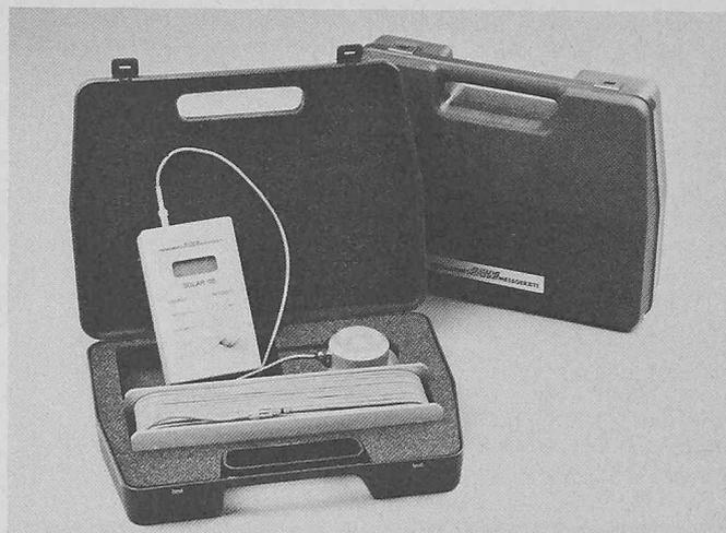
Solar 118 Sonnenintensitäts- und -Energie-Messgerät
