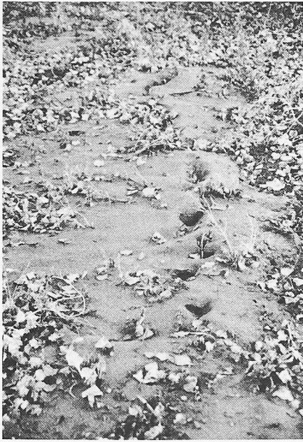
Bild 11. Bodenverflüssigungserscheinungen (Sandausspülungen) in alluvialen Flussablagerungen in der Nähe der Eisenbahnstation von San Angelo dei Lombardi
