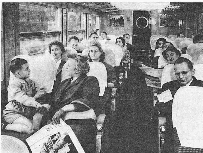
Fig. 8. Intérieur d'une «voiture-fauteuils», équipée de sièges à dossier inclinable, de la SNCF. Clarté et confort poussé sont les caractéristiques de cette réalisation moderne, inspirée des avions.
