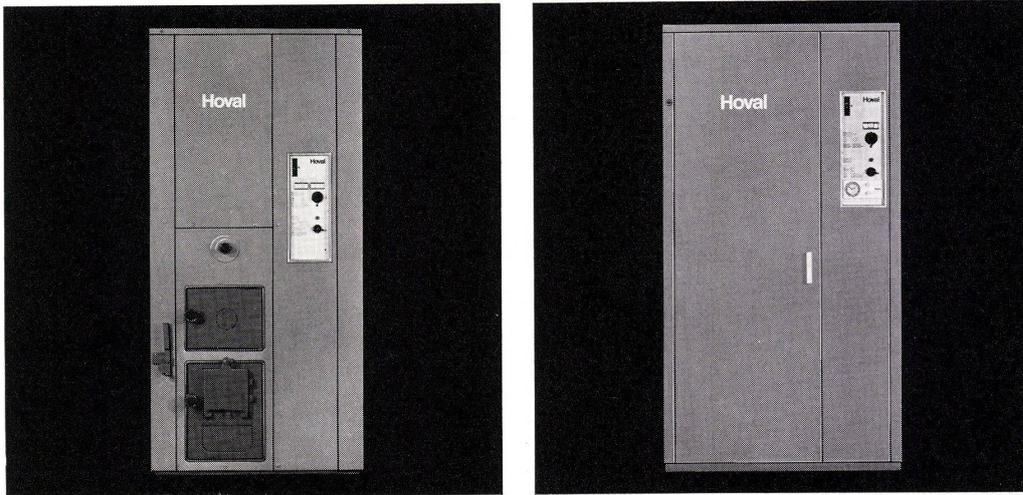
Die neuen Hoval-Automaten Typ TK-GT für Oelfeuerung und Typ TKM-A für Umstellbrand vereinigen Zentralheizungskessel, korrosionsfester Warmwasserboiler, Automatik (Raumsteuerung mit oder ohne Schaltuhr oder Aussensteuerung), Umwälzpumpe, Mischventil und Druck-Expansionsgefäß.
