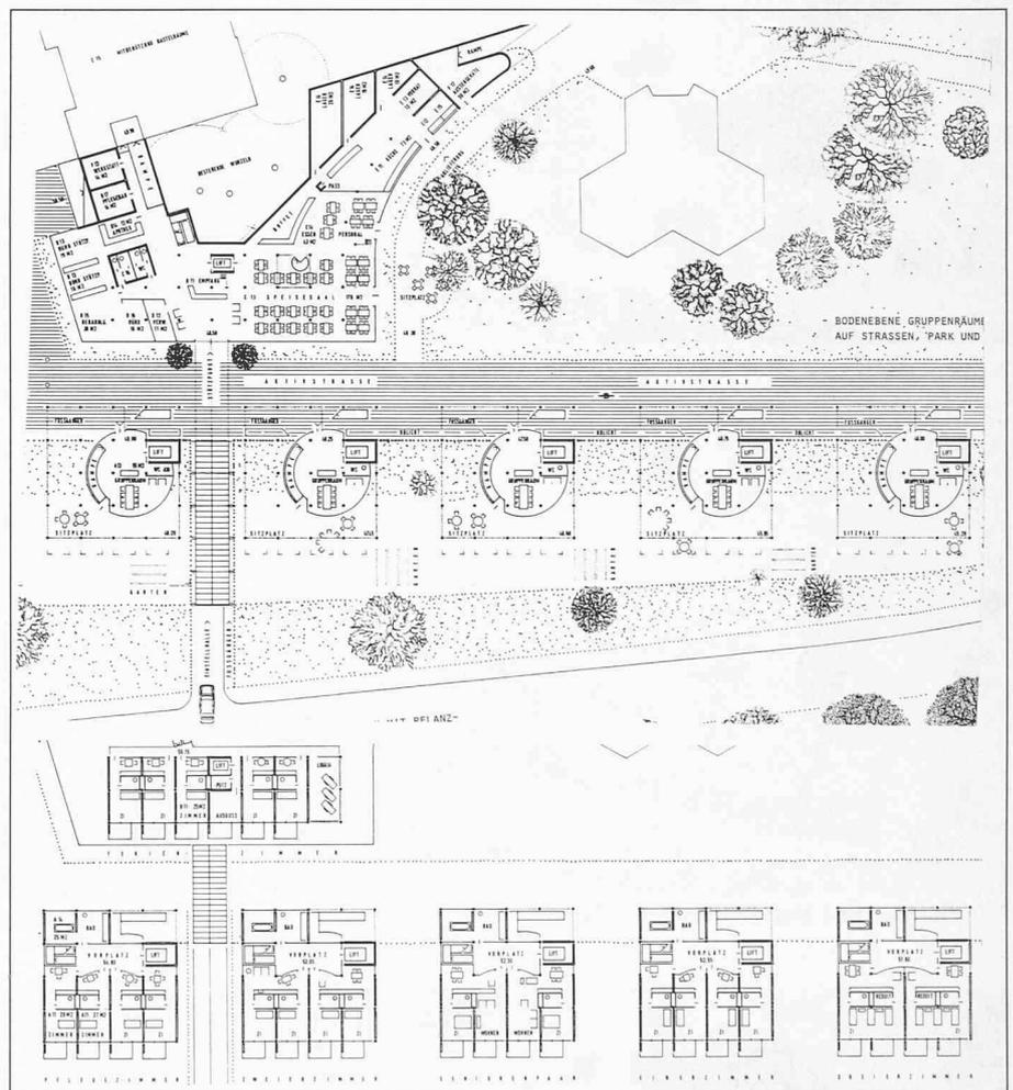
Rechts oben: Grundriss Erdgeschoss 1:900
