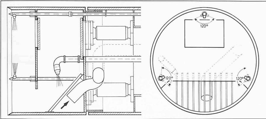
Bild 8. Aufbau des in Hamburg verwendeten Hydrojetschildes
