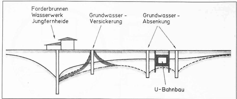
Bild 6. Anordnung der Versickerungsbrunnen im Absenktrichter der Wasserwerke
