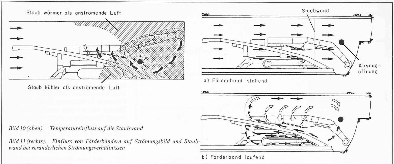
Bild 10 (oben). Temperatureinfluss auf die Staubwand
