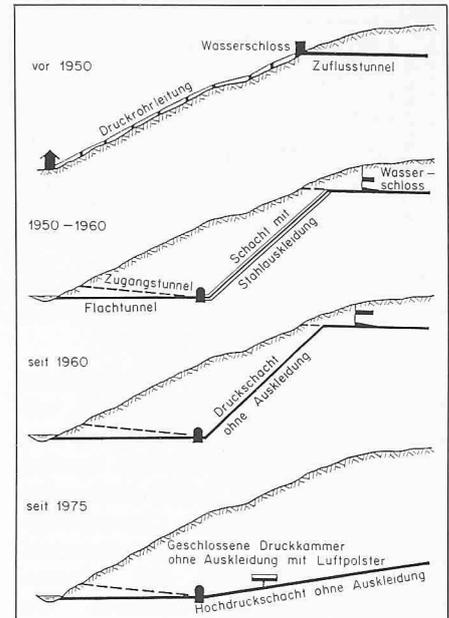
Bild 1. Entwicklung der Gestaltung von Wasserkraftanlagen in Norwegen
