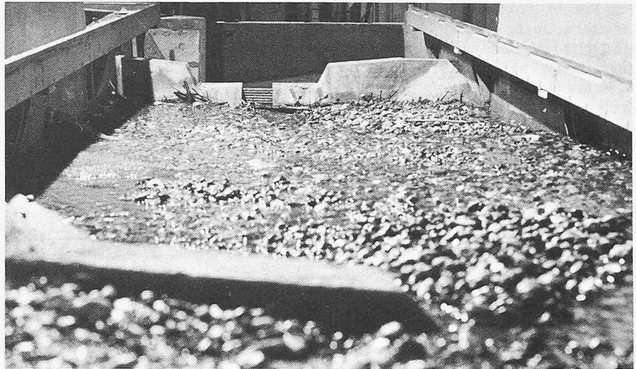
Bild 5. Endstadium nach Versuch 80 (Beschickung von insgesamt 200 000 m<sup>3</sup> Geschiebe). Blick von 150 m oberhalb der Sperre bachabwärts
