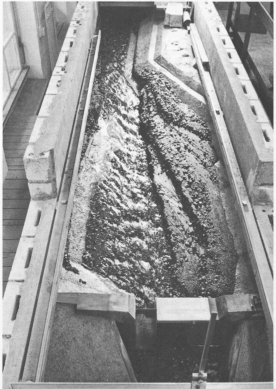
Bild 4. Endstadium des Spülversuches 38 (nach 21 Stunden in Natur). In drei terrassenartigen Stufen hat sich das Wasser in den Verlandungskörper einerosiert. Die Strömung konzentrierte sich gegen das Ende dem rechten Ufer entlang. Die Ursache dazu ist der nach rechts verschobene Schlitz. Die Spülvirkung im linken Beckenteil (rechts im Bild) ist relativ schlecht.
