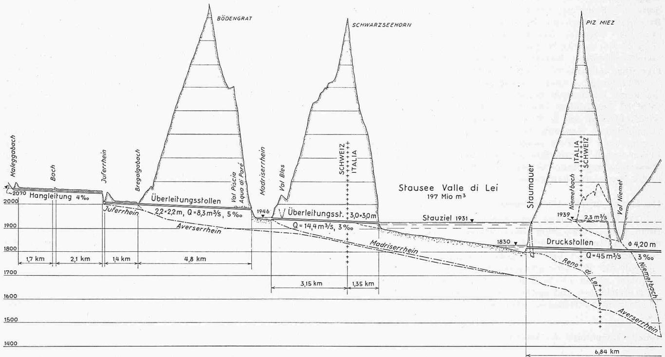
Bild 3. Uebersichtslängenprofil, Längen 1 : 150 000, Höhen 1 : 15 000
