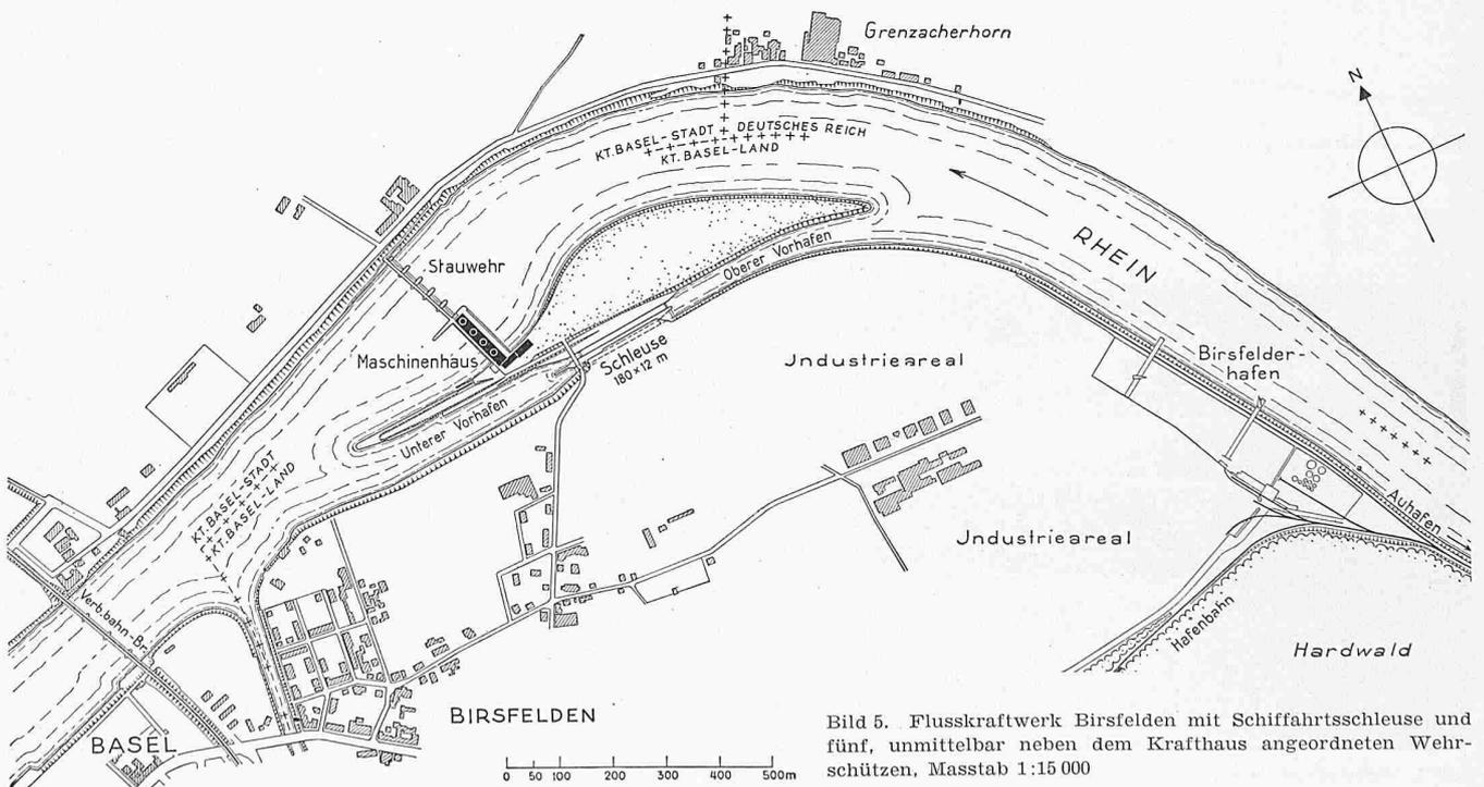
Bild 5. Flusskraftwerk Birsfelden mit Schifffahrtsschleuse und fünf, unmittelbar neben dem Krafthaus angeordneten Wehrschützen, Masstab 1:15 000
