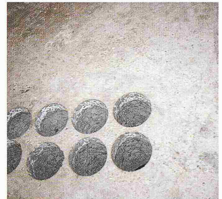
5 Beton mit erhöhter Brandbeständigkeit nach Brandbelastung
