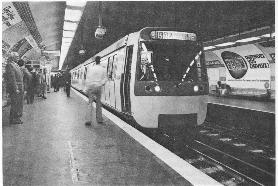
Bild 1. Metro Paris: Anwendung der Grossprofiltechnik
