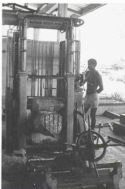
Bild 3. Ausbildung an der Bandsäge, Centre forestier de formation professionnelle de Morondava, Madagaskar
