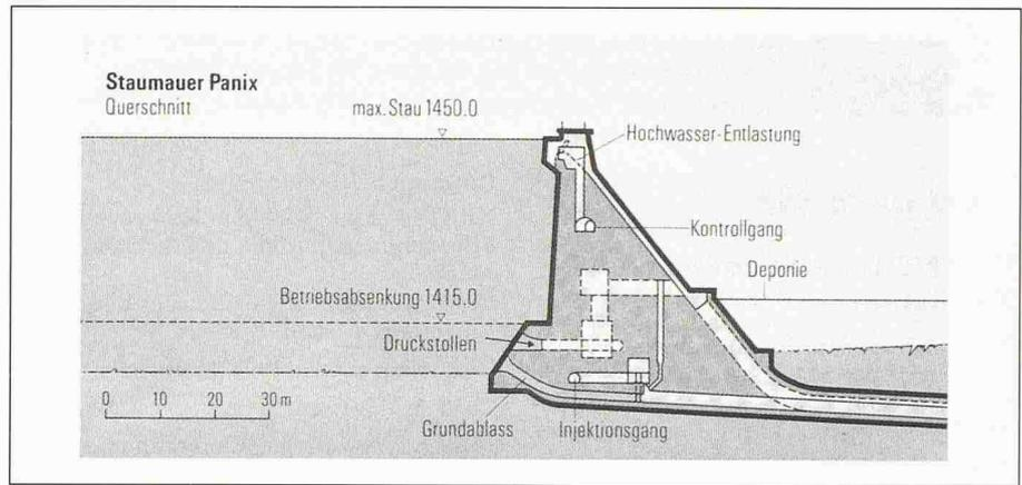
Querschnitt der Panixer Staumauer
