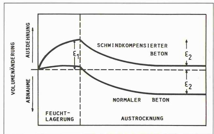
Bild 1. Volumenänderung in schwindkompensiertem und normalem Beton. Während der Feuchtbehandlung expandiert der Beton mit Expansionsmittel um den Betrag  $\epsilon_1$ . Beim Austrocknen schwindet das Material um den Betrag  $\epsilon_2$ . Ist die Expansion grösser als das Schwindmass, so tritt keine Volumenverkleinerung ein. Bei normalem Beton ohne Expansionsmittel tritt durch die Austrocknung eine Volumenverkleinerung um den Wert  $\epsilon_2$  ein
