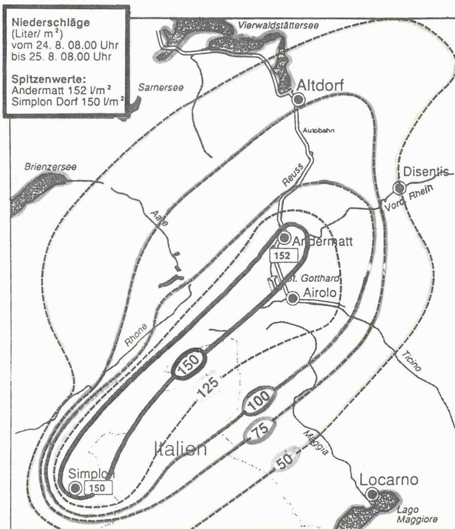
Bild 3. Niederschläge und Einzugsgebiet beim Unwetter 1987 (Bauamt Uri)
